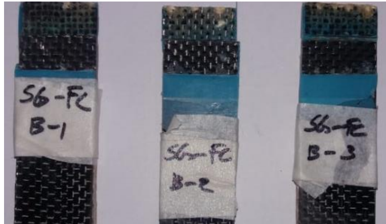
Figura 80: Foto das superfícies de ruptura das juntas coladas de SV-FC para BETAMATE.
