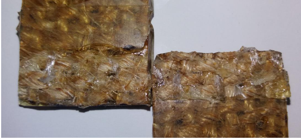
Figura 68: Detalhe da superfície de ruptura do SV-SV para resina (CP 2).
