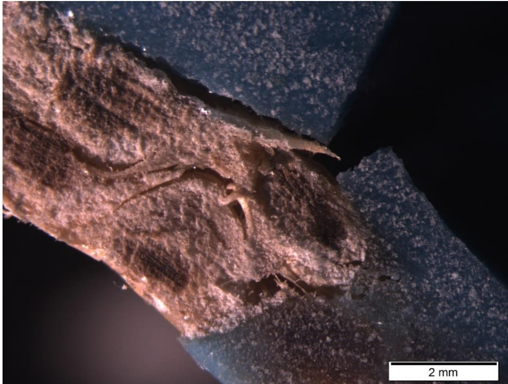
Figura 99: Foto aumentada da quebra do substrato de S-S para BETAMATE.
