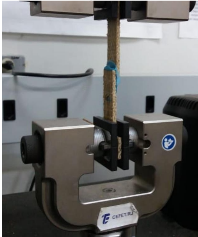
Figura 44: Junta de SV-SV sendo ensaiada.
