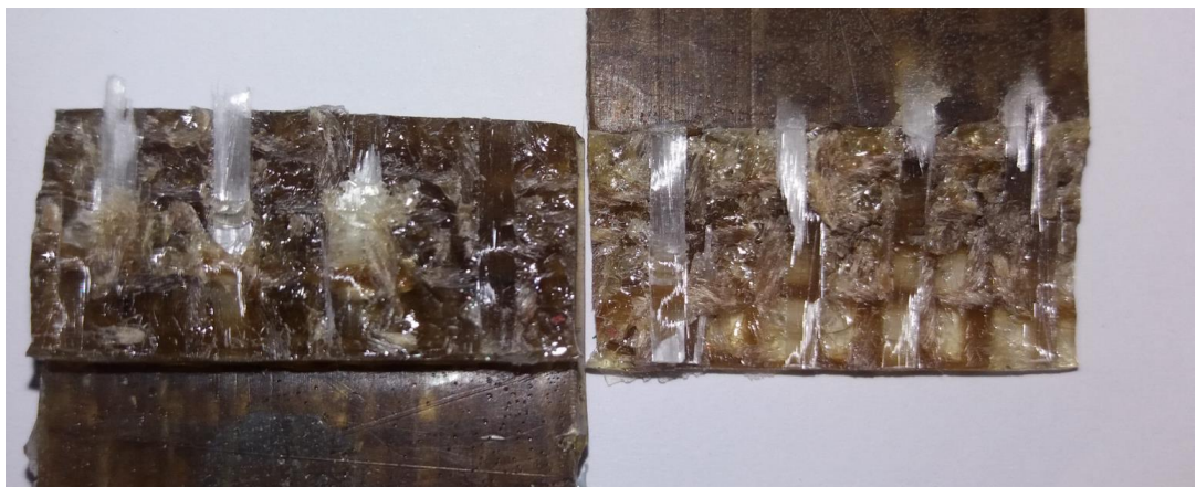
Figura 74: Detalhe da superfície de ruptura da JV-JV para resina.
