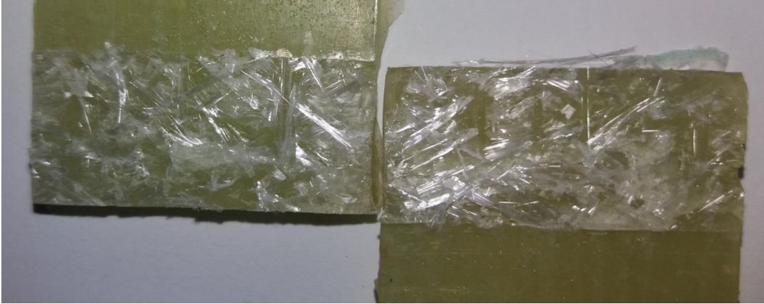
Figura 51: Detalhe da superfície de ruptura da FV-FV para resina.
