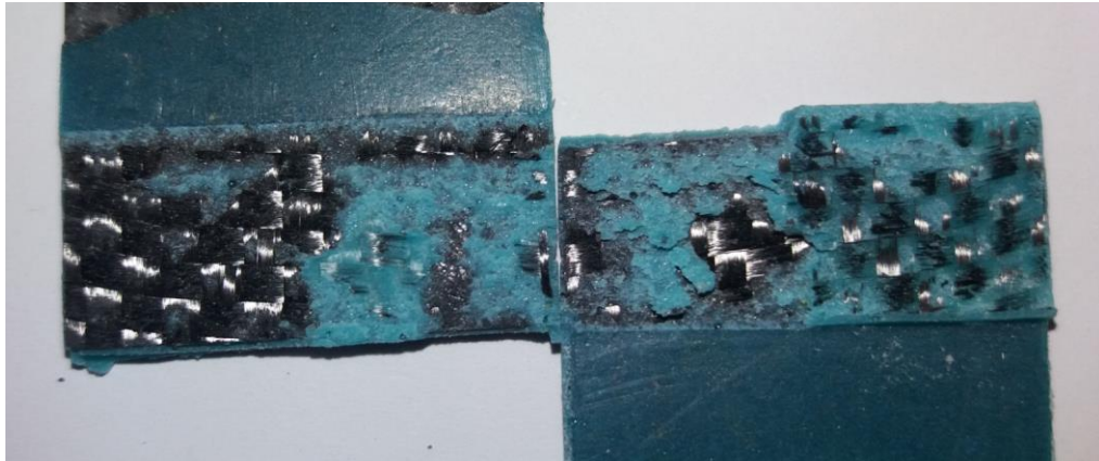
Figura 57: Detalhe da superfície de ruptura da FC-FC para BETAMATE (CP 3).
