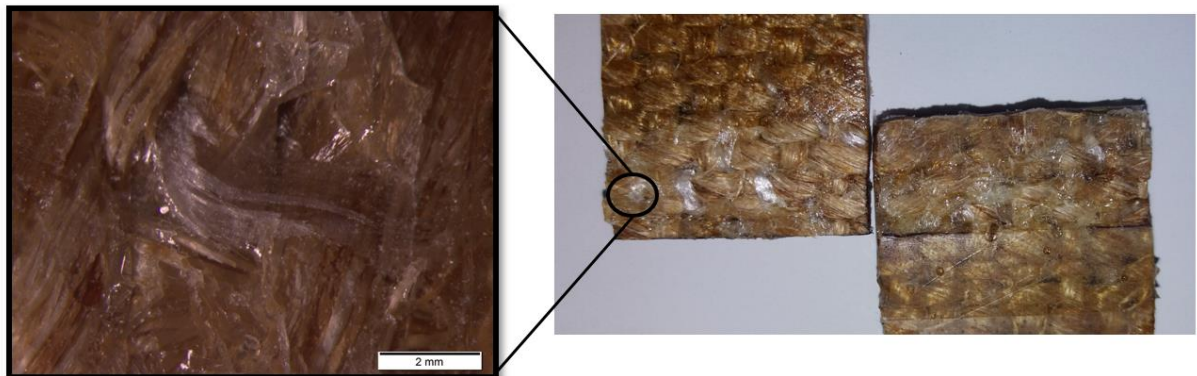
Figura 71: Foto aumentada do SV para resina com detalhe da fibra de reforço.
