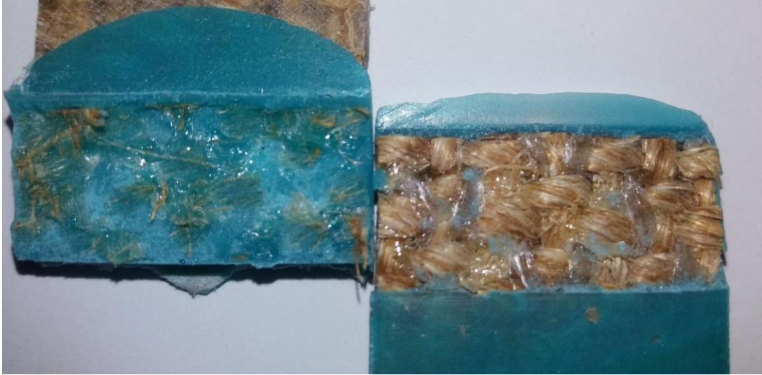
Figura 64: Detalhe da superfície de ruptura do SV-SV para BETAMATE (CP 1).
