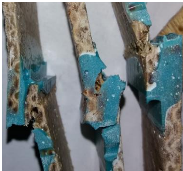
Figura 98: Detalhe da quebra dos substratos de S-S para BETAMATE.
