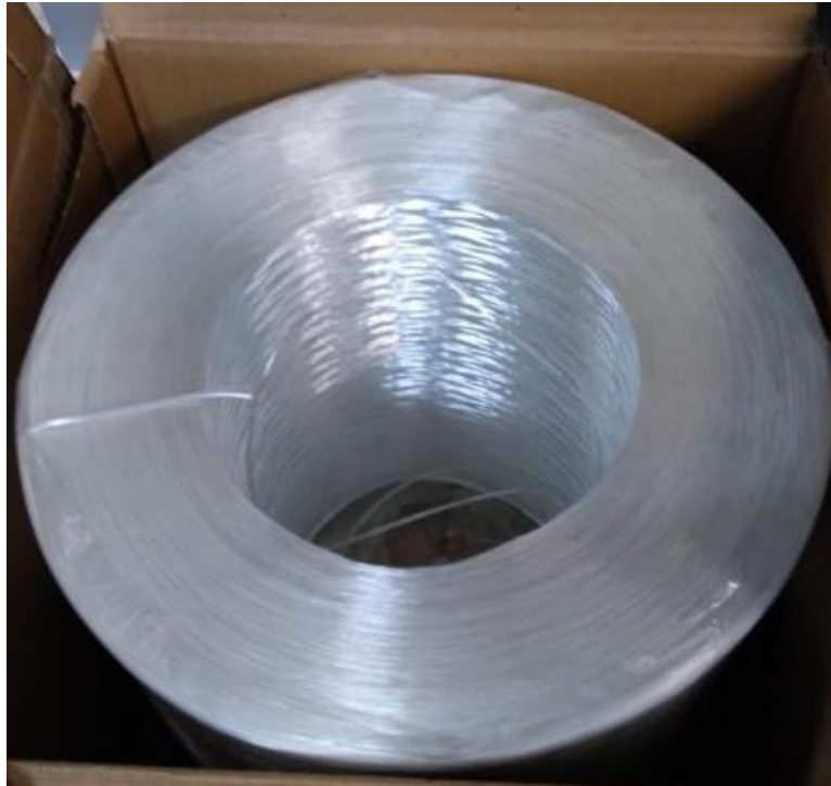
Figura 21: Fibra de Vidro utilizada como reforço.
