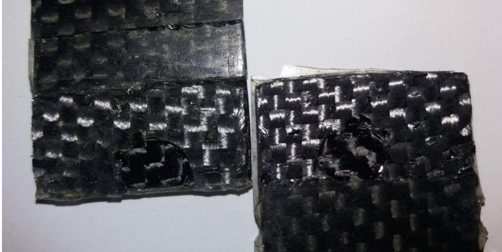
Figura 61: Detalhe da superfície de ruptura da FC-FC para resina (CP 2).
