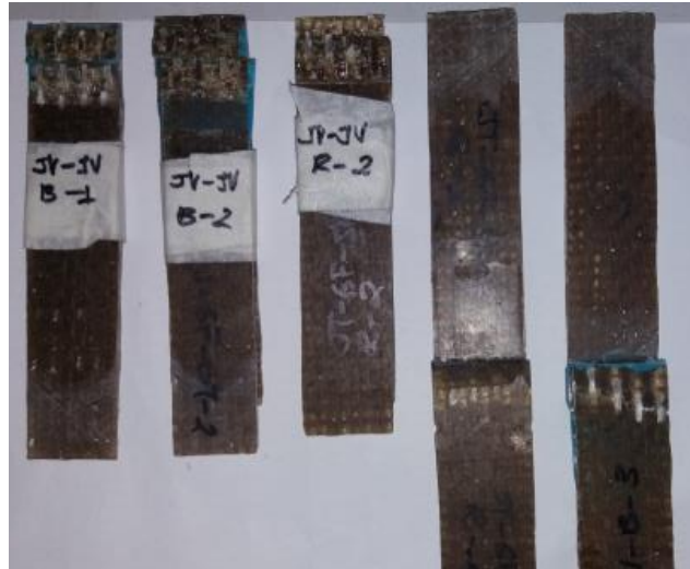
Figura 72: Foto das superfícies de ruptura das juntas coladas de JV-JV.
