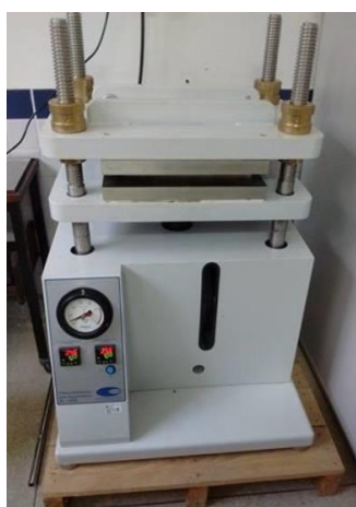
Figura 42: Prensa hidráulica aquecida utilizada.
