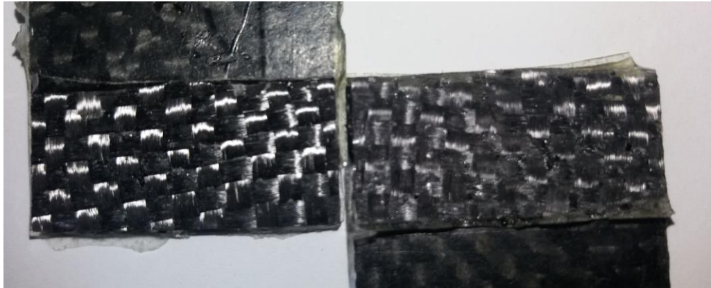
Figura 59: Detalhe da superfície de ruptura da FC-FC para resina (CP 1).
