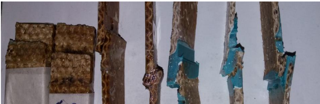
Figura 97: Foto das superfícies de ruptura das juntas coladas de S-S.
