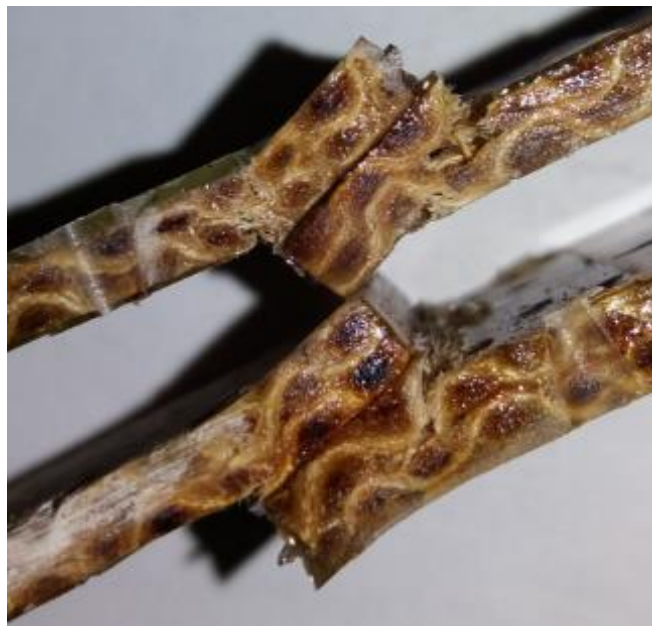
Figura 100: Detalhe da quebra dos substratos de S-S para a resina.
