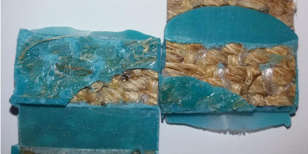
Figura 66: Detalhe da superfície de ruptura do SV-SV para BETAMATE (CP 3).
