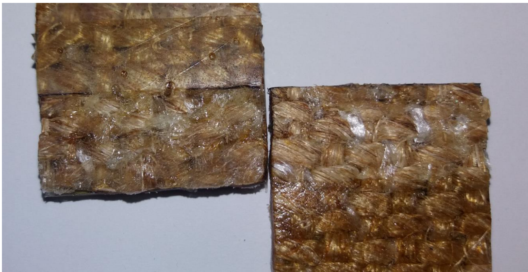
Figura 69: Detalhe da superfície de ruptura do SV-SV para resina (CP 3).
