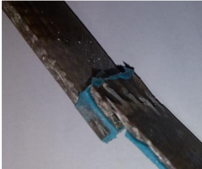
Figura 77: Detalhe da quebra do substrato de JV-JV para BETAMATE.
