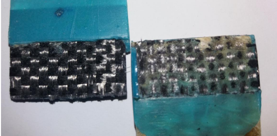
Figura 82: Detalhe da superfície de ruptura do SV-FC para BETAMATE (CP 3).
