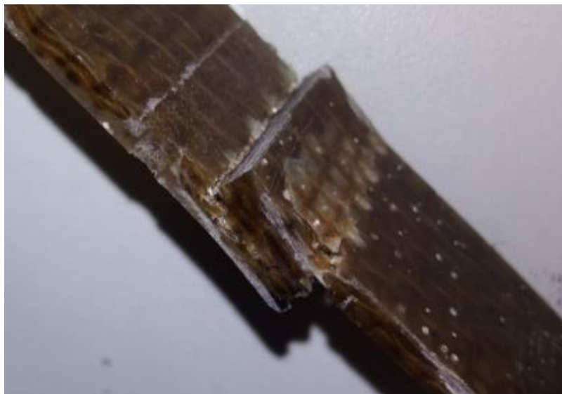
Figura 78: Detalhe da quebra de substrato de JV-JV para resina.
