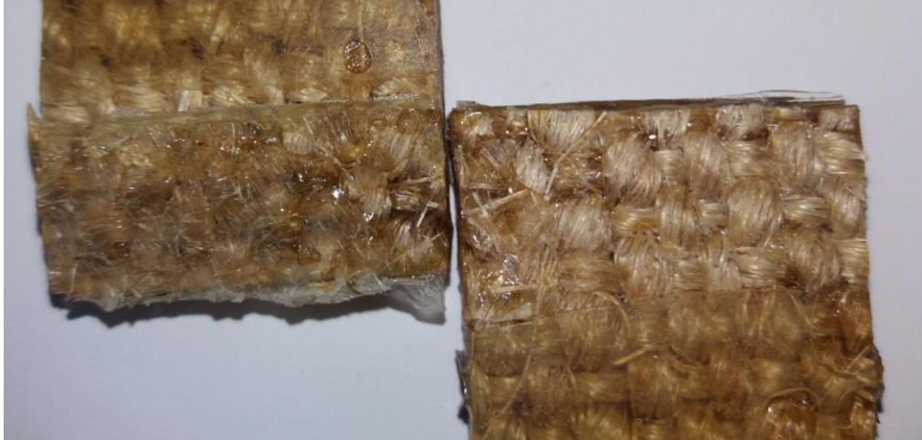
Figura 101: Detalhe da superfície de ruptura do S-S para resina (CP 1).
