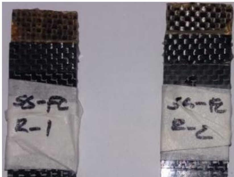
Figura 81: Foto das superfícies de ruptura das juntas coladas de SV-FC para resina.
