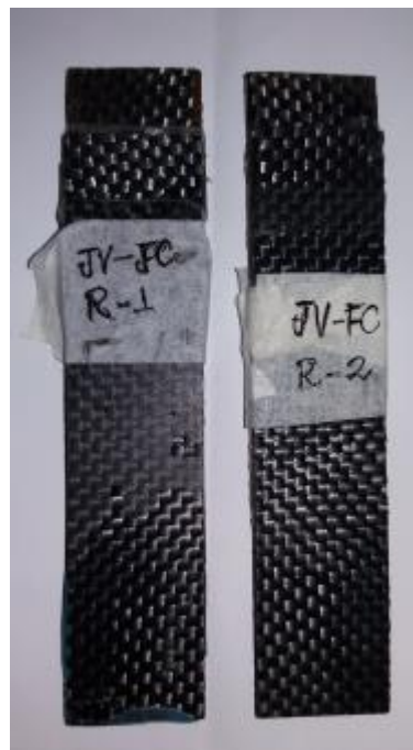
Figura 89: Foto das superfícies de ruptura das juntas coladas de JV-FC para resina.
