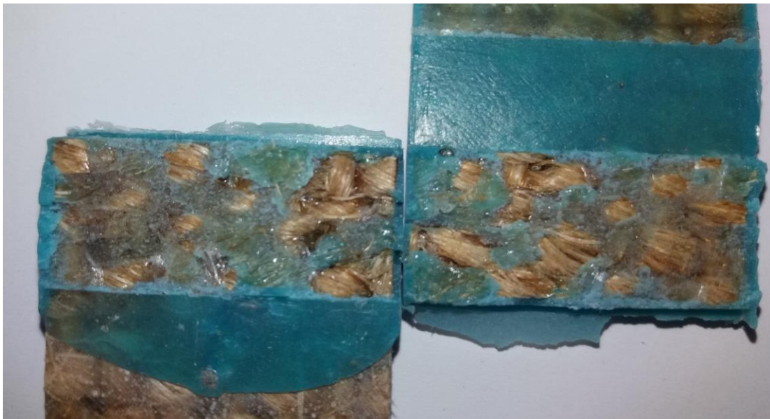
Figura 65: Detalhe da superfície de ruptura do SV-SV para BETAMATE (CP 2).
