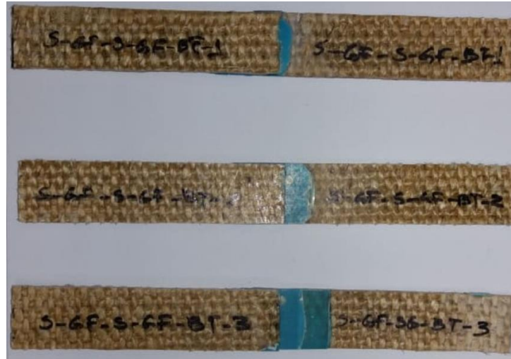
Figura 43: Juntas de SV-SV (B) curadas e identificadas.
