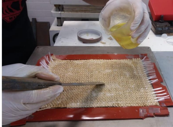
Figura 30: Processo de hand lay up do compósito Sisal/FV.
