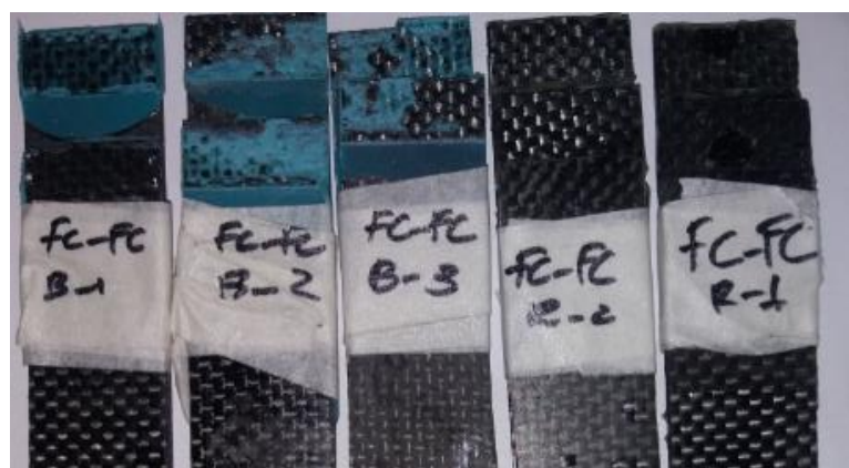
Figura 54: Foto das superfícies de ruptura das juntas coladas de FC-FC.
