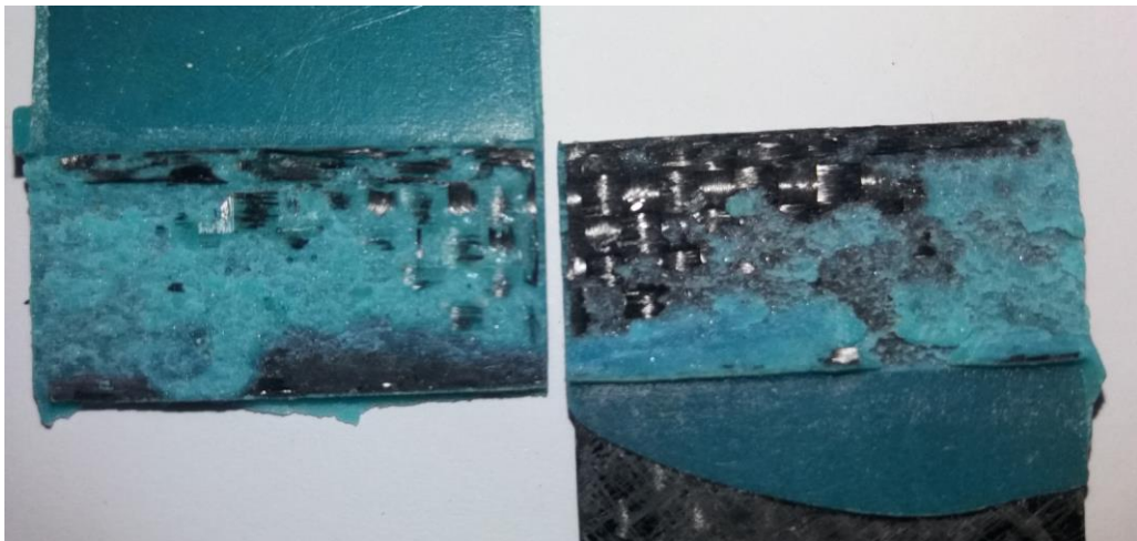
Figura 56: Detalhe da superfície de ruptura da FC-FC para BETAMATE (CP 2).
